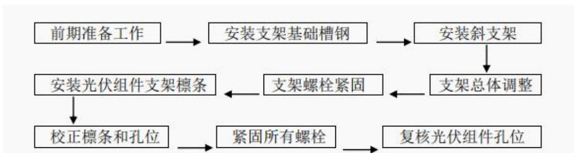
图 2-5 太阳能电池组件支架安装工艺
